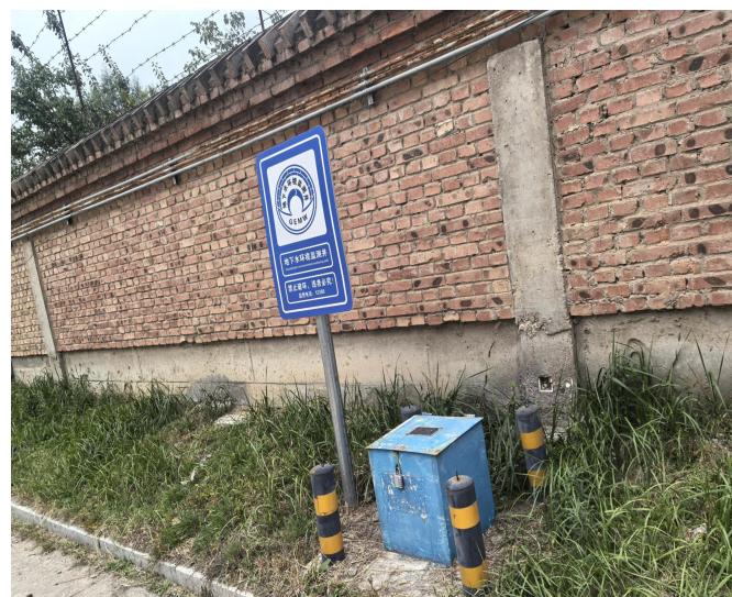
地下水监测井
