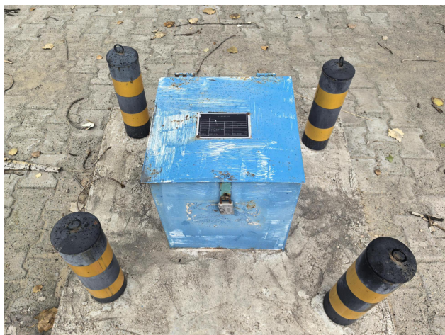
地下水监测井
